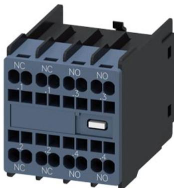
Вспомогательный выключатель с лицевой стороны, 2 НО + 2 НЗ Токпровод 1 НЗ, 1 НЗ, 1 НО, 1 НО для 3RH2 и 3RT2 Пружинная клемма .1/.2, .1/.2, .3/.4, .3/.4
